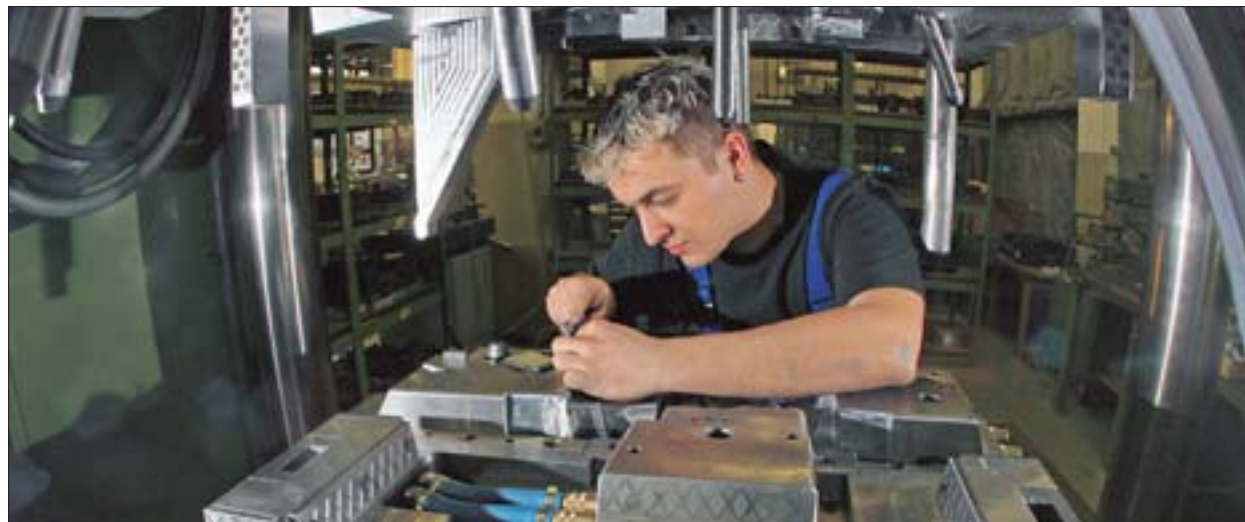
Ohne gutes Auge geht es nicht – Werkzeugmechaniker müssen auch mit Spritzgussformen klarkommen, die aus mehr als 250 Einzelteilen bestehen und für die Automobilindustrie bestimmt sind. Foto: dpa
